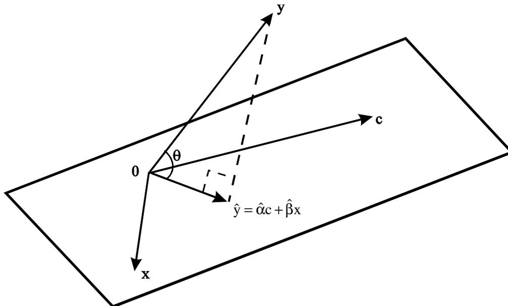
Der Punkt  $y = (y_1, \dots, y_T)'$  wird auf die durch die Konstante  $c = (1, \dots, 1)'$  und den Regressor  $x = (x_1, \dots, x_T)$  aufgespannte Ebene projiziert. Dadurch bildet sich in  $\hat{y}$  ein rechter Winkel. Der Abstand zwischen  $y$  und  $\hat{y}$  ist dabei im Sinne der euklidischen Metrik minimal.
